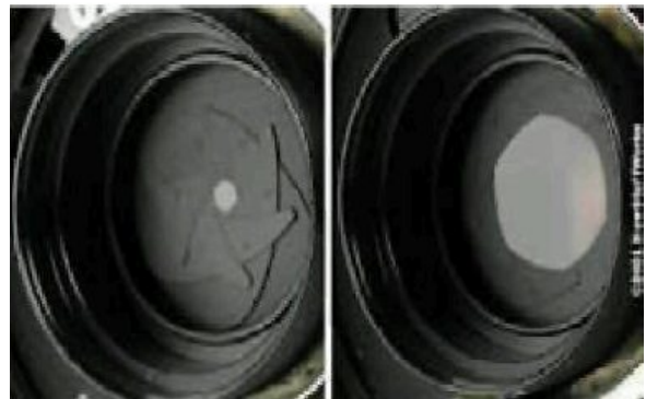
Diyaframda, Küçük Açıklık (sol) f/22 ve Büyük Açıklık (sağ) f/2 Değerleri
